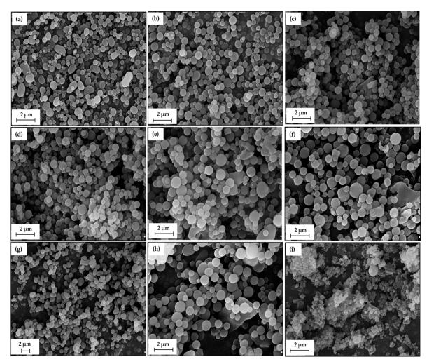
**Figure 1.** SEM images of LC-2a (1:1 wt./wt.) (a), LC-2a (2:1 wt./wt.) (b), LC-2a (4:1 wt./wt.) (c), LC-2b (1:1 wt./wt.) (d), LC-2b (2:1 wt./wt.) (e), LC-2b (4:1 wt./wt.) (f), LC-4 (1:1 wt./wt.) (g), LC-4 (2:1 wt./wt.) (h) and LC-4 (4:1 wt./wt.) (i).
