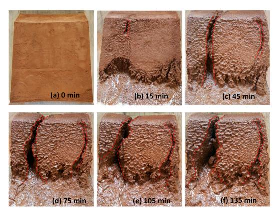
**Figure 8.** The erosion of the 45° slope surface: (**a**) 0 min, (**b**) 15 min, (**c**) 45 min, (**d**) 75 min, (**e**) 105 min, and (**f**) 135 min.
