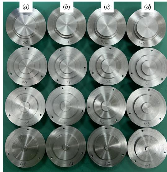
**Figure 6.** Surface to be tested: (a)  $Sa$  1.6  $\mu\text{m}$ ; (b)  $Sa$  3.2  $\mu\text{m}$ ; (c)  $Sa$  4.5  $\mu\text{m}$ ; (d)  $Sa$  5.8  $\mu\text{m}$ .
