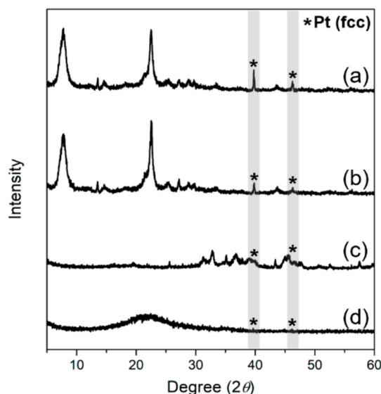
**Figure 5.** XRD patterns of supported Pt-Sn catalysts: (a) Pt-Sn/Beta(300), (b) Pt-Sn/Beta(38), (c) Pt-Sn/ $\theta$ -Al<sub>2</sub>O<sub>3</sub>, and (d) Pt-Sn/Q6.
