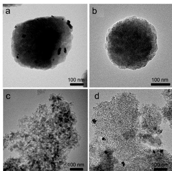
**Figure 4.** TEM images of supported Pt-Sn catalysts: (a) Pt-Sn/Beta(300), (b) Pt-Sn/Beta(38), (c) Pt-Sn/ $\theta$ -Al<sub>2</sub>O<sub>3</sub>, and (d) Pt-Sn/Q6.
