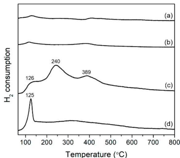
**Figure 6.** H<sub>2</sub>-TPR profiles of supported Pt-Sn catalysts; (a) Pt-Sn/Beta(300), (b) Pt-Sn/Beta(38), (c) Pt-Sn/ $\theta$ -Al<sub>2</sub>O<sub>3</sub>, and (d) Pt-Sn/Q6.
