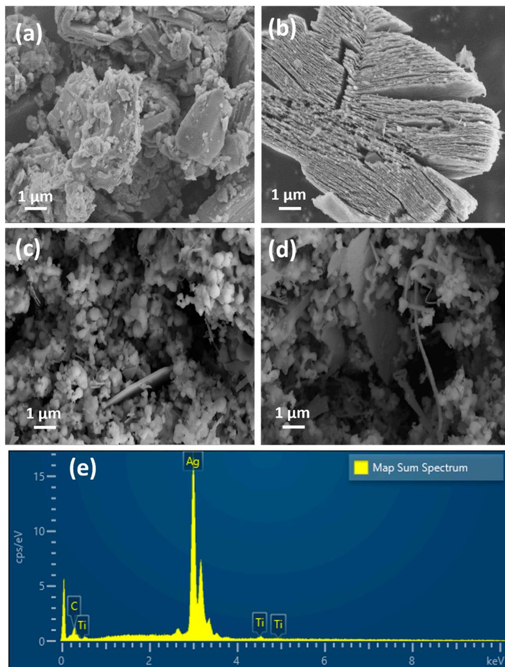
**Figure 4.** FESEM micrograph of (a)  $\text{Ti}_3\text{AlC}_2$ , (b)  $\text{Ti}_3\text{C}_2\text{T}_x$ , (c)  $\text{Ag}_{20}\text{@Ti}_3\text{C}_2\text{T}_x$ , (d)  $\text{Ag}_{50}\text{@Ti}_3\text{C}_2\text{T}_x$ , (e) EDX spectrum of  $\text{Ag}_{50}\text{@Ti}_3\text{C}_2\text{T}_x$ .
