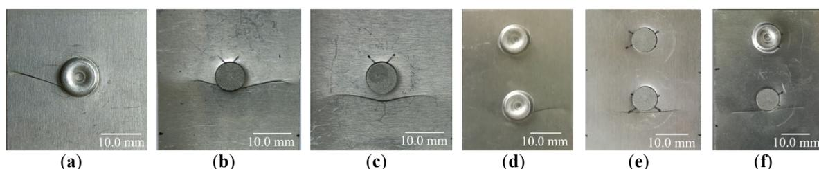
**Figure 12.** Fatigue failure modes of SPR joints. (a) SA; (b) AS-1; (c) AS-2; (d) SAT; (e) AST; (f) SAF.
