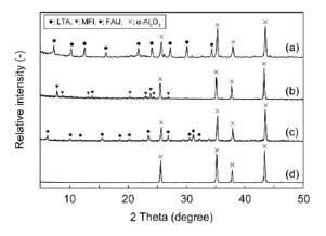
Figure 4. XRD patterns of (a) LTA-, (b) MFI-, (c) FAU-type zeolite membranes, and (d) support tube.
